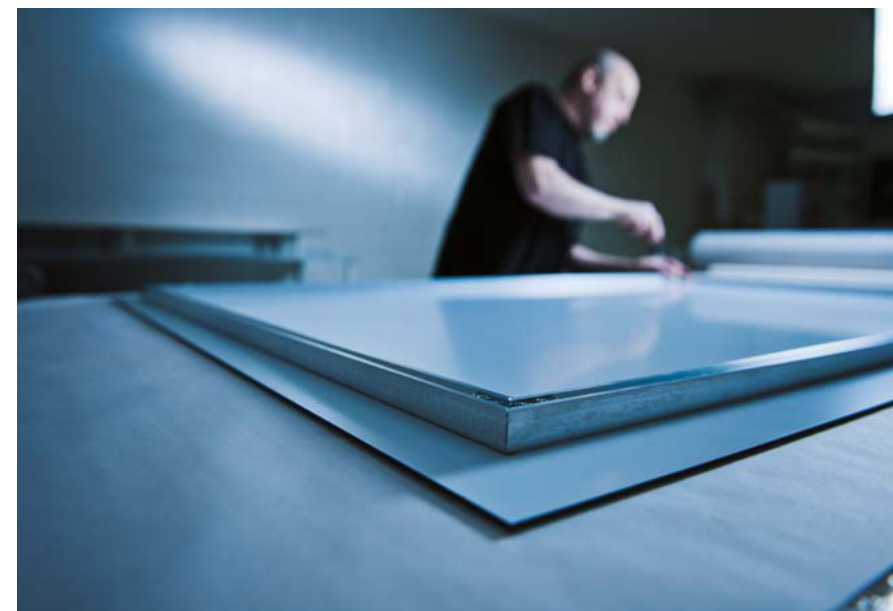
1 Kaschierungen auf Aluverbundplatten erzeugen besonders glatte Oberflächen.
